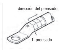
Terminales entallados /tubulares
