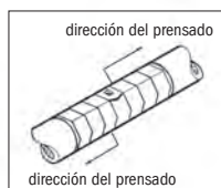
Terminales de presión DIN
